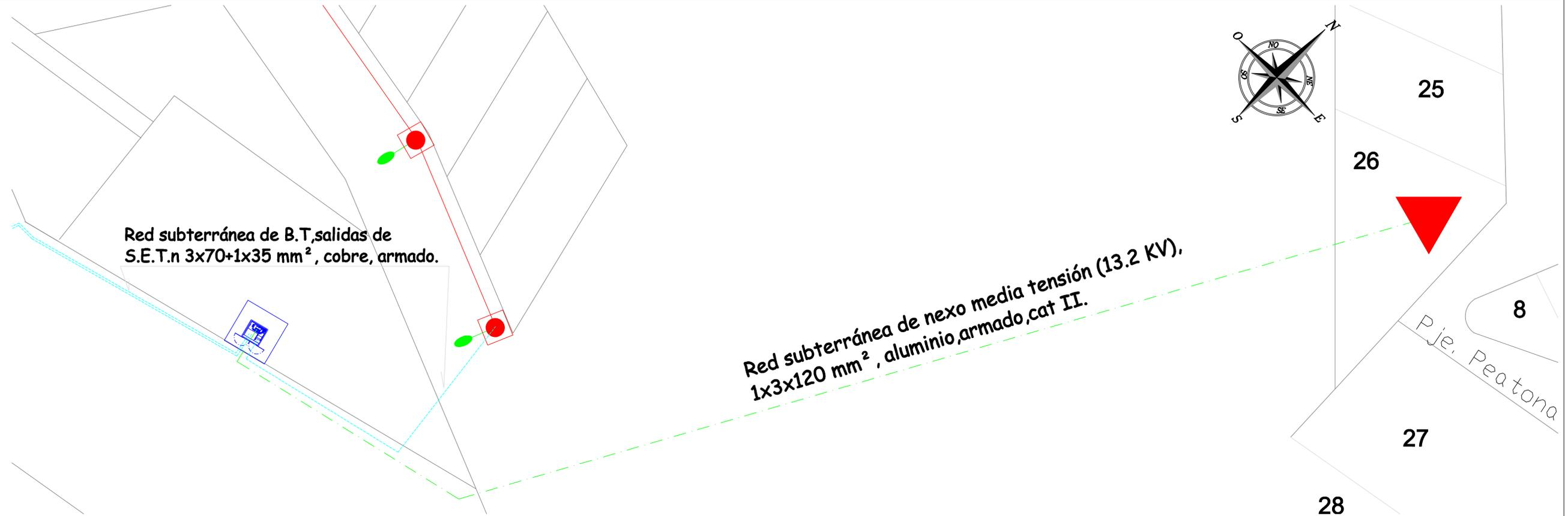
Red subterránea de B.T, salidas de S.E.T.n 3x70+1x35 mm<sup>2</sup>, cobre, armado.
